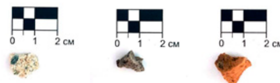
Сл. 5 Примероци (малтер, камен и тула) извлечени од црквата
